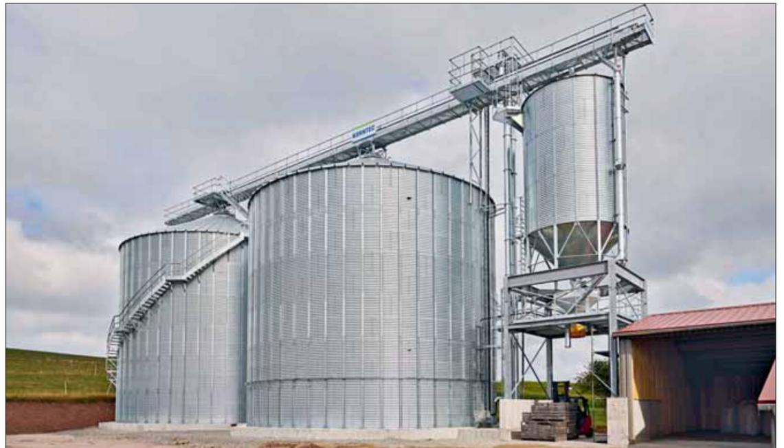
Zwei Lagersilos mit umlaufender Treppe vom Boden bis zur Laufsteg-Brücke, rechts daneben das Entnahmesilo
